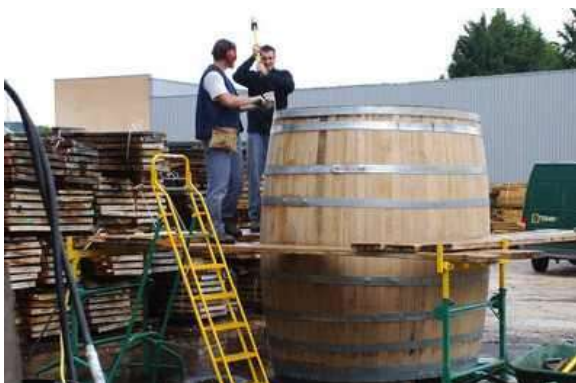
Millimeterarbeit für 6.000 Liter Wein: Ein Riesenfaß wird zusammengebaut.
